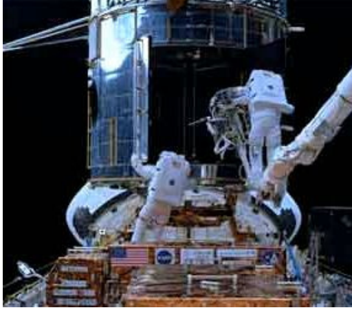
Şekil 6. NICMOS kızılötesi algılayıcısı HUBBLE Uzay Teleskobu'na yerleştiriliyor.
